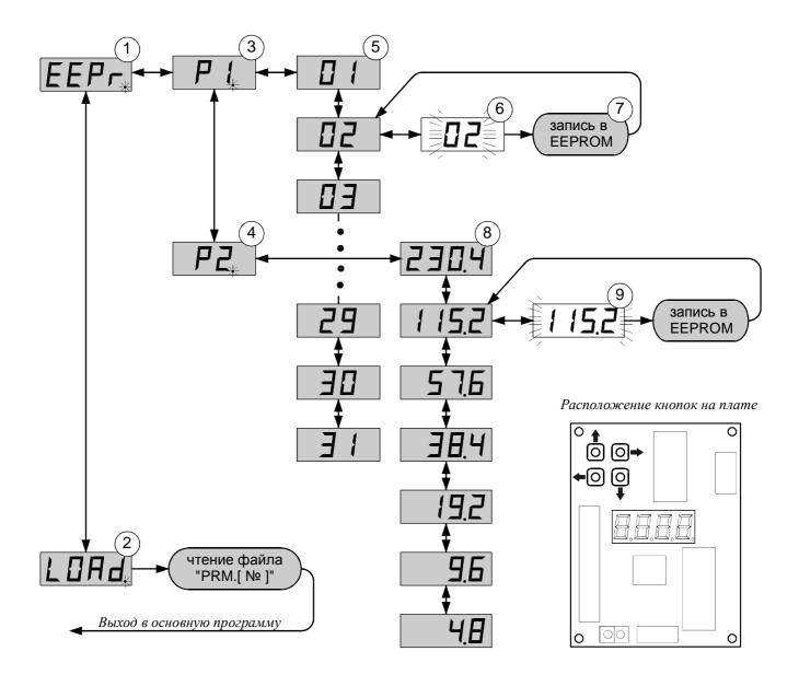
Вход в режим редактирования и загрузки параметров осуществляется одновременным нажатием и удержанием кнопок " ← " и " → " в течение 4-х секунд.
